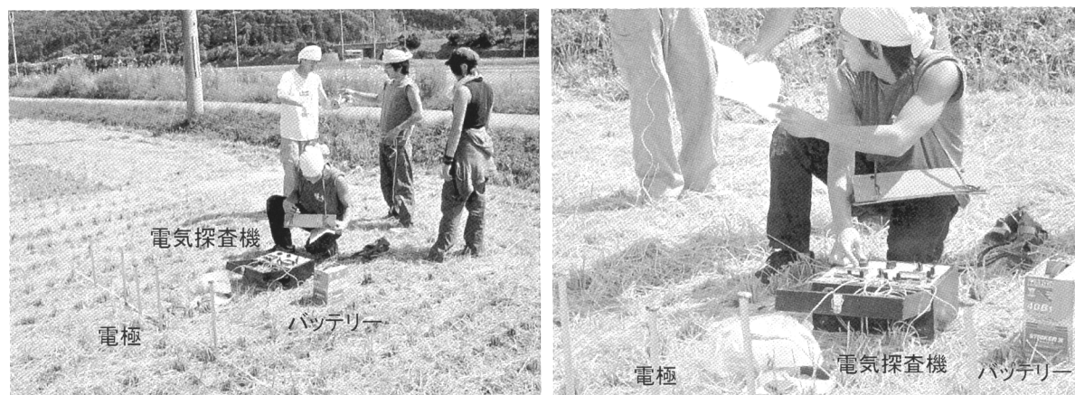
写真2 三田市当野付近の武庫川谷底平野における電気探査のようす。
