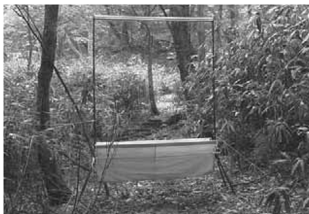
図2 ハーブトラップ 2本の青色支柱の間に、数cm間隔で縦に張られたナイロン製の糸に飛翔するコウモリが接触すると、下部の袋に落下する。
