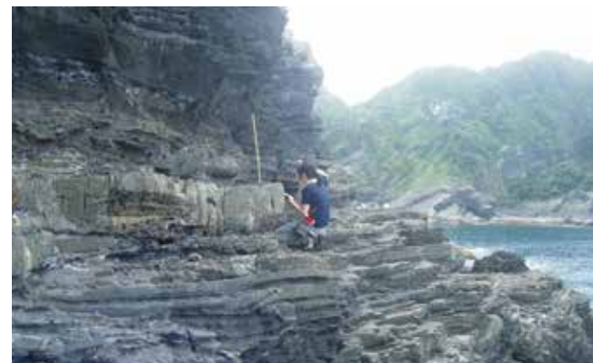
図3 露頭で岩石の種類や地層の厚さを記録する
