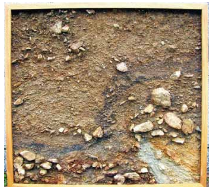
写真 1 山崎断層帯・暮坂峠断層のトレンチ発掘調査で現れた過去の大地震による地層のずれ（はぎとり標本）
