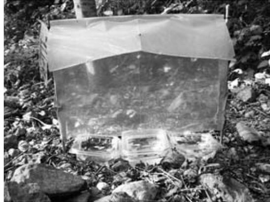
図3. FIT (衝突板トラップ)
