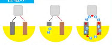
まず亜鉛板が溶けて、電気の芫である電子ができます。
