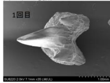
サメの歯化石レプリカ 1回目 5回目 10回目 ブルーミックスソフト使用
