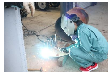
図6 窯用ドラム缶を溶接
