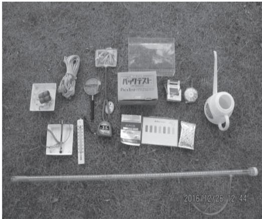
**環境調査** 気温、水温、透視度、pH、COD です。温度は市販の寒暖計や水温計、透視度は透明のアクリルパイプで制作、pH や COD は市販のキットを使用しました。採水はほぼ流れの中央部よりできるだけゴミや藻類が入らぬようにしました。透視度計は手製で、現地での測定ですので参考程度です。正式な機器との対比が必要ですができておりません。(写真左は環境調査道具類)
