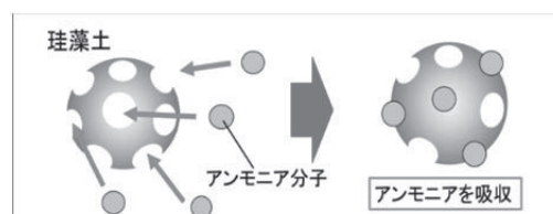
図 2 珪藻土のアンモニア吸収のしくみ
