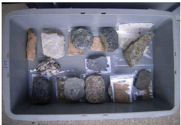
写真 7-7 水洗・除菌処理の完了した地質標本
