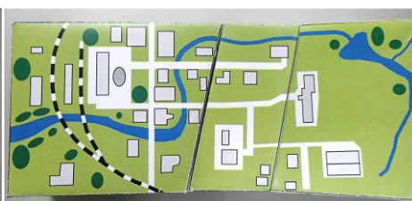
⑨ 完成した右横ずれ断層ペーパークラフトを上からみた図です。川や道路がまっすぐに続いていることに注意してください。
