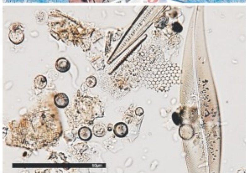
① 海底の泥を採取して、化石や化学組成を調べる ② 化石となる珪藻の殻。左下の黒い線の長さは50マイクロメートル(1ミリの20分の1)
