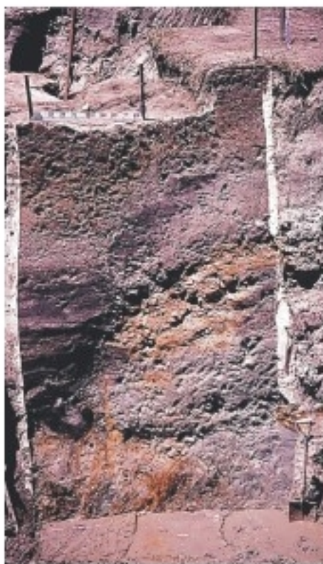
トレンチ調査で発掘された野島断層による地層のずれ
