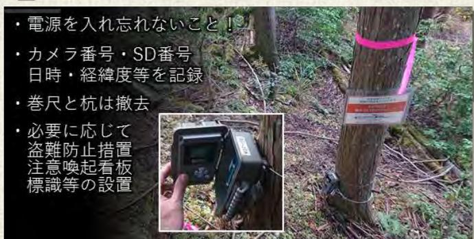
※一般的な自動撮影カメラの焦電型赤外線センサーは垂直方向の検知角度が狭くなっているため正三角形の撮影範囲を画像の下2/3程度に収める
