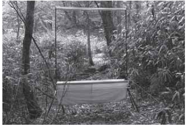
図2 ハーブトラップ 2本の青色支柱の間に、数cm間隔で縦に張られたナイロン製の糸に飛翔するコウモリが接触すると、下部の袋に落下する。
