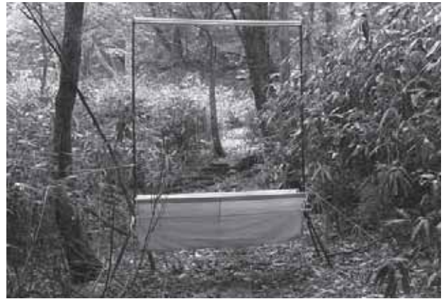
図2 ハープトラップ 2本の青色支柱の間に、数cm間隔で縦に張られたナイロン製の糸に飛翔するコウモリが接触すると、下部の袋に落下する。
