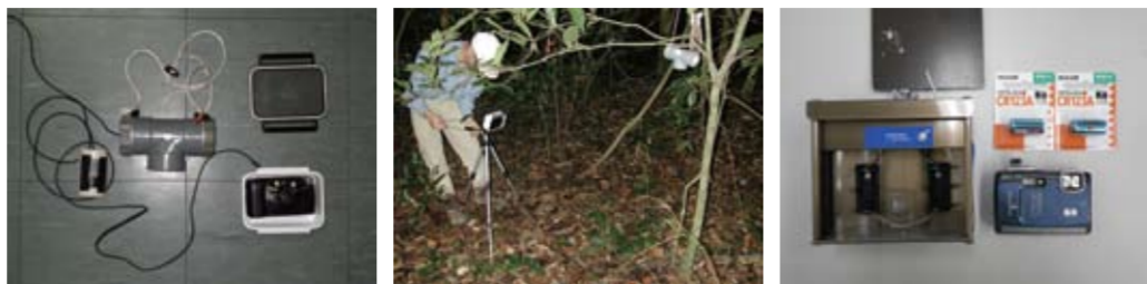
写真1: 自作した自動撮影カメラシステム。左から防犯センサー、防犯センサーを保護するための塩ビ管、弁当箱と中に入れるコンパクトカメラ。 写真2: 自動撮影カメラシステムを用いた調査の様子。右上のセンサーの下に果実を並べて、それらの果実を食べる動物を記録する。カメラの方向を調整しているのは共同研究者の大学院生。 写真3: 最新型の自動撮影カメラ。左が赤外線センサーを組み込んだケースで、右が防水デジタルカメラ。左のケースの青ライン内の白い部分がセンサー。
