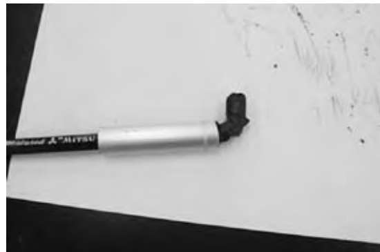
図6. 型枠に入れたクレヨンを鉛筆で押し出す
