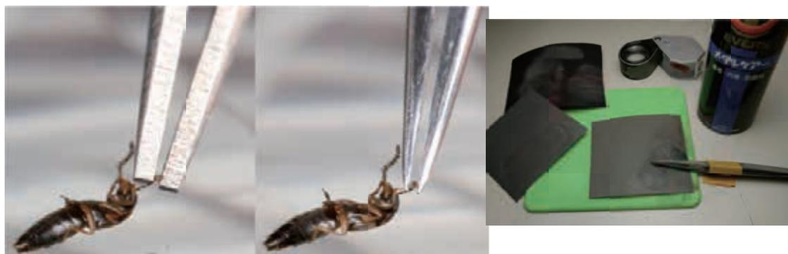
図3 研磨によって調整したピンセットの先端；左：未調整、右：調整済み（写っている昆虫は体長3mmのハネカクシ科の一種）
